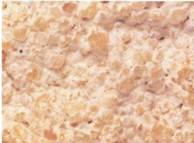
Zdjęcie 3: Zaprawa z wapnem daje gwarancję przyczepności i szczelności.
